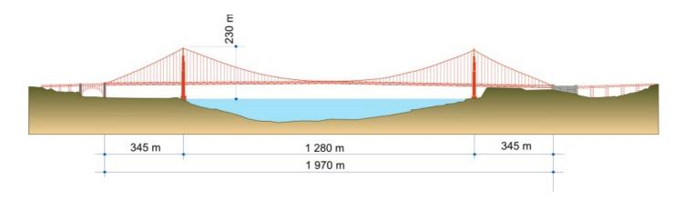
Le tablier d'un pont est une structure porteuse qui supporte les charges du trafic routier et les transmet aux appuis ou aux éléments de suspension (suspentes ou arcs).
