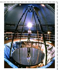
En faisant varier la vitesse de rotation, on peut faire varier la courbure de la parabole et donc la distance focale du miroir. Plus la couche de mercure est épaisse, plus le champ de variations peut être important.
