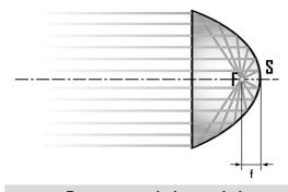
S = sommet de la parabole F = foyer de la parabole f = distance de la focale
